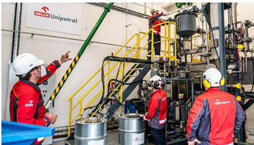
Testovací pyrolyzní jednotku na zpracování odpadních plastů zprovoznil ve svém litvínovském závodě Orlen Unipetrol. V následujících třech letech v ní bude zkoumat chemickou recyklaci plastů i způsob, jak ji využít v běžné výrobě. | foto: Orlen Unipetrol
